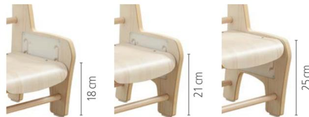
POUR CHANGER LA HAUTEUR DE L'ASSISE, DÉVERROUILLEZ LE DOIGT D'INDEXAGE SITUÉ SOUS L'ASSISE, FAITES GLISSER L'ASSISE LE LONG DES RAINURES POUR VENIR LA POSITIONNER À LA HAUTEUR SOUHAITÉE ET ENFIN VERROUILLEZ LE DOIGT D'INDEXAGE.
