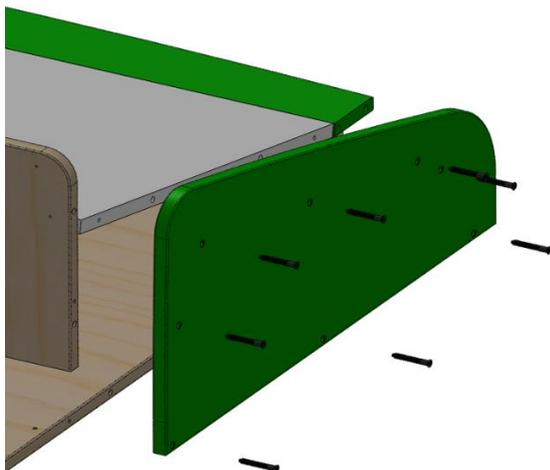
Positionner et fixer le panneau écritoire sur le côté gauche puis sur le côté droit à l'aide des vis confirmat et d'une clé 6 pans SW4.
