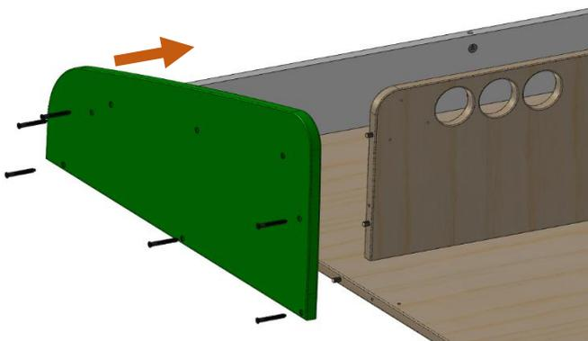
Positionner et fixer le côté gauche sur le panneau arrière, le support et le dessus à l'aide des vis confirmat et d'une clé 6 pans SW4.
