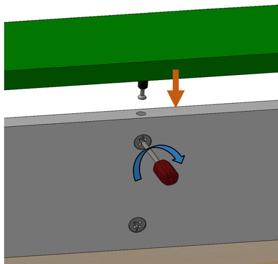
Positionner et fixer le bandeau supérieur sur le dessus à l'aide d'un tournevis cruxiforme : effectuer un quart de tour pour serrer l'excentrique. Répéter l'opération sur le 2e excentrique
