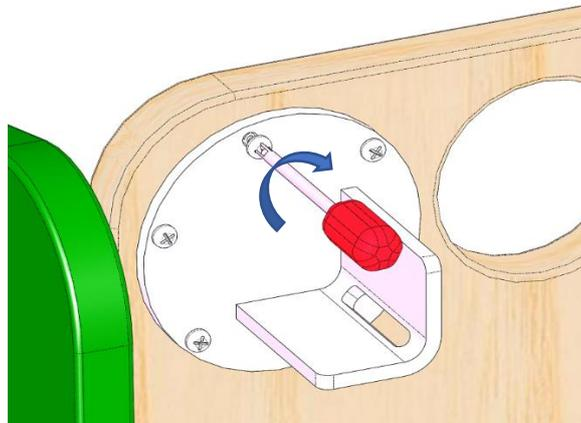
3/ Positionner le pied sur la platine pour faire correspondre les trous et le passage des vis :
