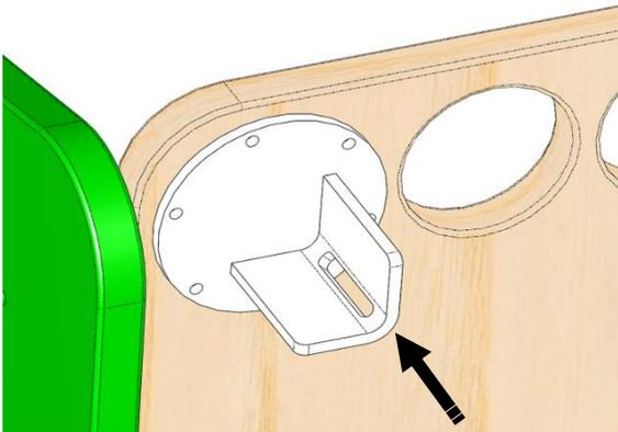
2/ Fixer la platine à l'aide d'un tournevis cruxiforme et de 6 vis à tête bombée 4,8x19 :
