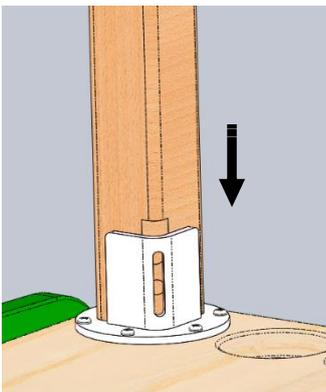
4/ fixer le pied à l'aide de 2 vis CHC 6x35 et d'une clé 6 pans SW5 :
