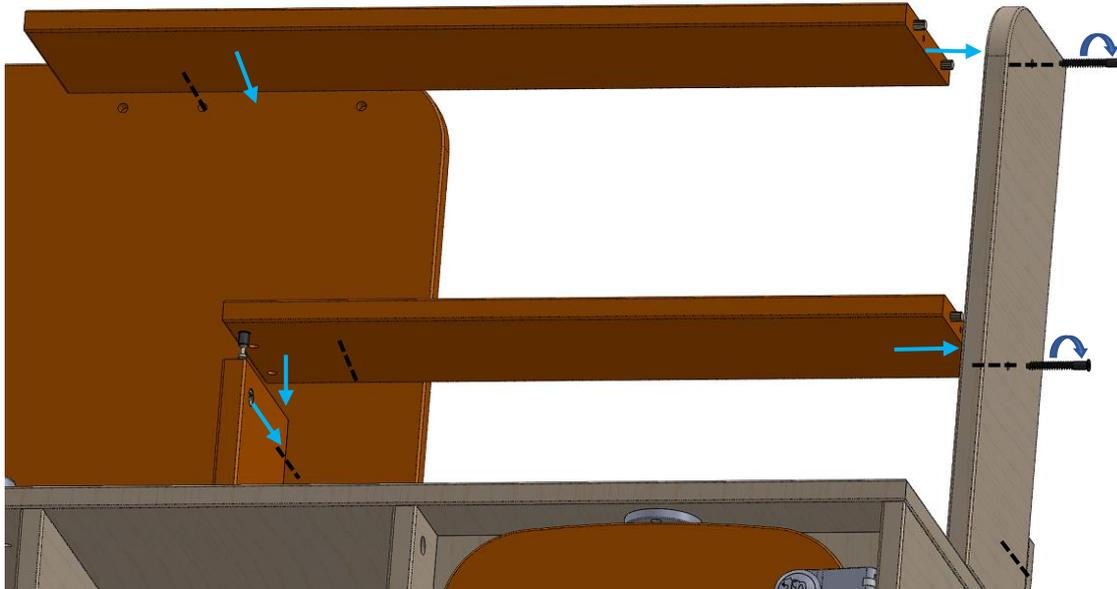
2/ Fixer l'ensemble grâce à 6 vis confirmat 5x50 (pointillés noirs) et 1 excentrique :
