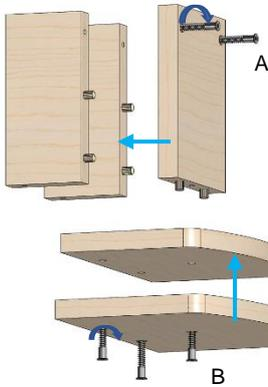
1/ Positionner les trois panneaux verticaux à l'aide des tourillons et fixer l'ensemble à l'aide de vis confirmat 5x50 (x2) et 5x70 (x3) :
