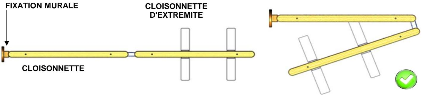
**3F) : POSITIONNEMENT DES STABILISATEURS (3 CLOISONNETTES REPLIABLES ET PLUS + FIXATION MURALE)**
