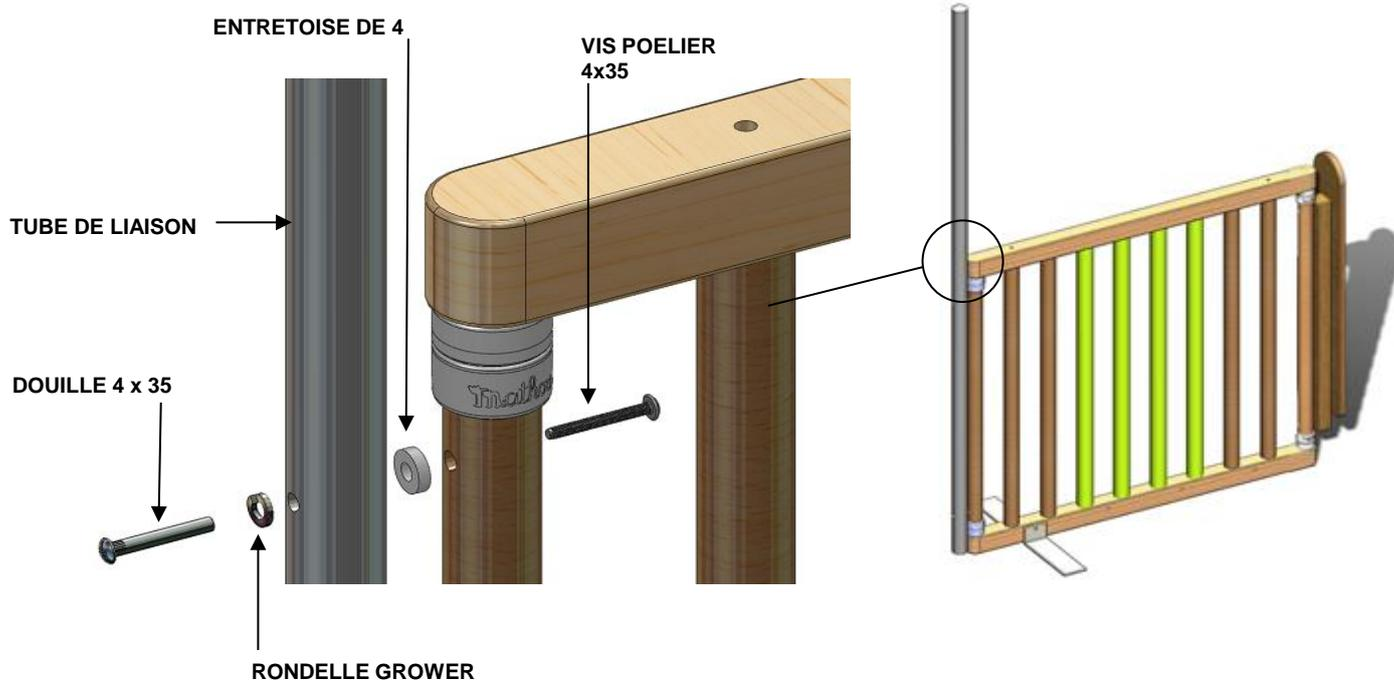
**8) : ASSEMBLAGE D'UN TUBE DE LIAISON AVEC UNE FIXATION MURALE :**
