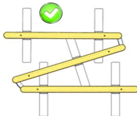
Lors d'une implantation avec 3 cloisonnettes ou plus, placer deux stabilisateurs sur les cloisonnettes d'extrémité ( le positionnement entre les deux stabilisateurs doit être le plus éloigné possible) . Pour toutes celles comprises entre, en positionner un seul par cloisonnette en tenant compte du repliage.
