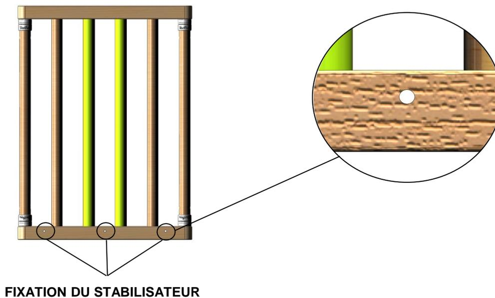
Chaque cloisonnette possède des perçages (3 ou 4 en fonction de la dimension) pour fixer les stabilisateurs
