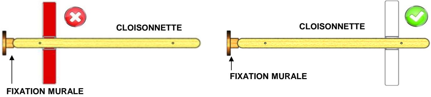
Lors d'une implantation avec une fixation murale, placer un stabilisateur le plus loin de la fixation murale.
