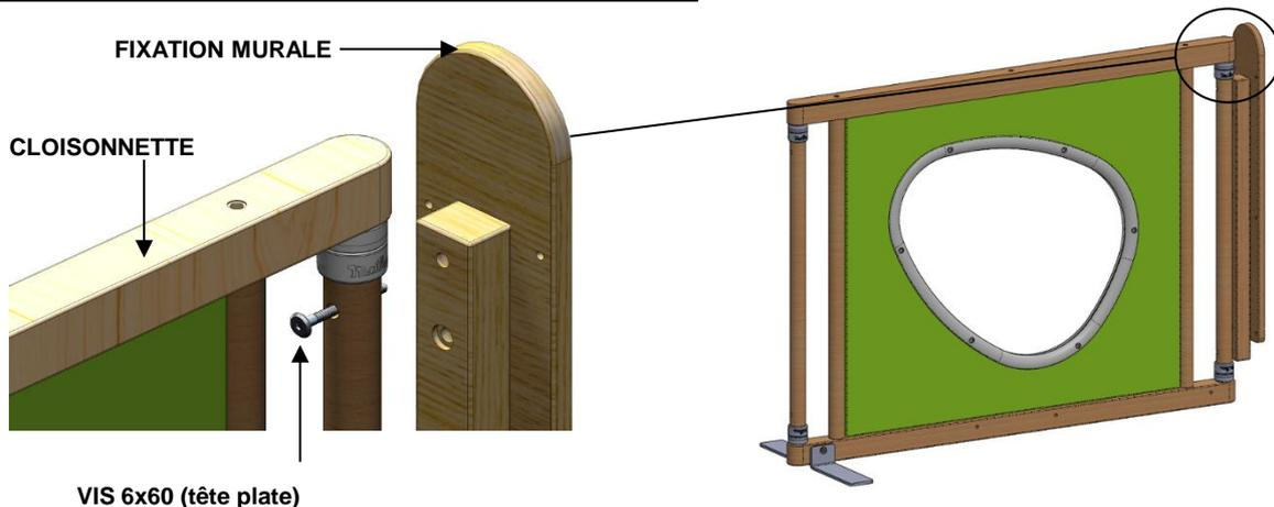
**7) : FIXATION TUBE DE LIAISON AVEC CLOISONNETTE :**
