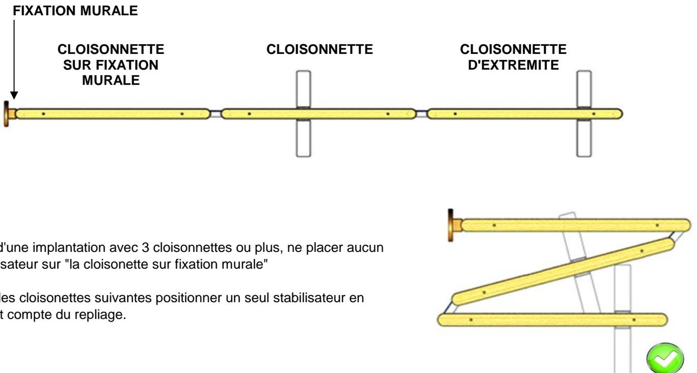
Lors d'une implantation avec 3 cloisonnettes ou plus, ne placer aucun stabilisateur sur "la cloisonnette sur fixation murale"
