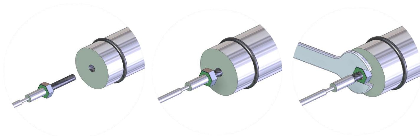
Positionner la partie filetée de la cablette sur le perçage du contre poids
