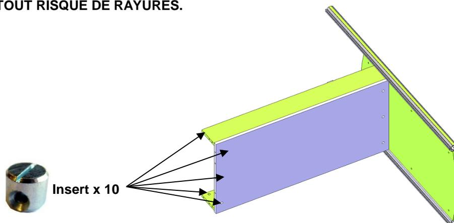
Les inserts doivent être positionnés sur la face supérieure du sommier et sur la face intérieure des raidisseurs.
