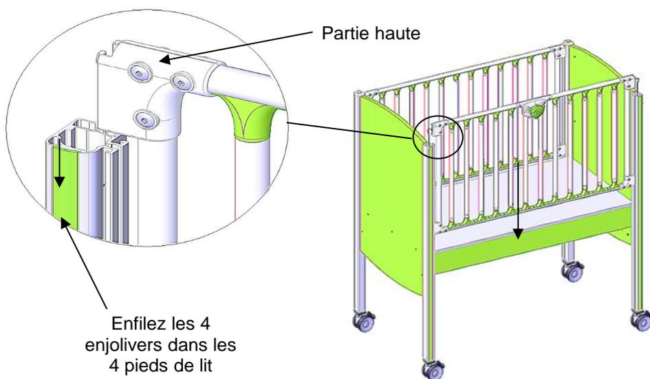
Enfilez le second côté ( bouton de commande en haut et vers l'extérieur ), sans emboîter la partie haute de l'ensemble
