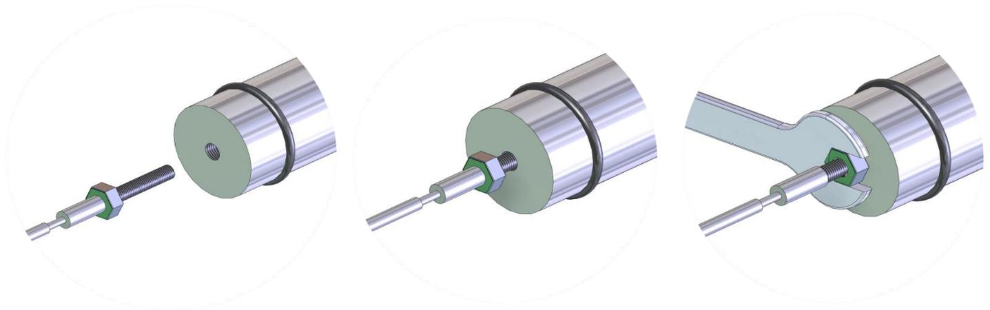
Positionnez la partie filetée de la cablette sur le perçage du contre poids
