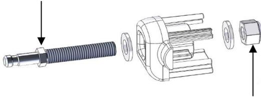
Serrer l'écrou à l'aide d'une clé à pipe de 19
