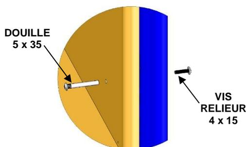
Fixer l'ensemble à l'aide de 4 vis relieurs 4 x 15 et de 4 douilles 5 x 35
